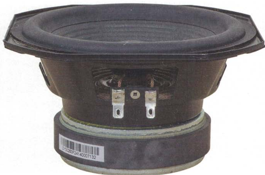
I woofer, identici tra loro, mostrano un adeguato gruppo magnetico dotato di fondello forato e bombato per favorire l'escursione del cono. Il cestello è in lamiera dalla flangia opportunamente sagomata. La membrana è realizzata in fibra di cellulosa trattata e stampata con nervature di rinforzo. L'anello di sospensione è in gomma.
