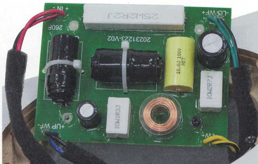
Il filtro crossover, avvitato sulla parete interna posteriore, a metà altezza del mobile, esibisce componenti di tipologia ed affidabilità in linea con le esigenze di qualità del diffusore.
