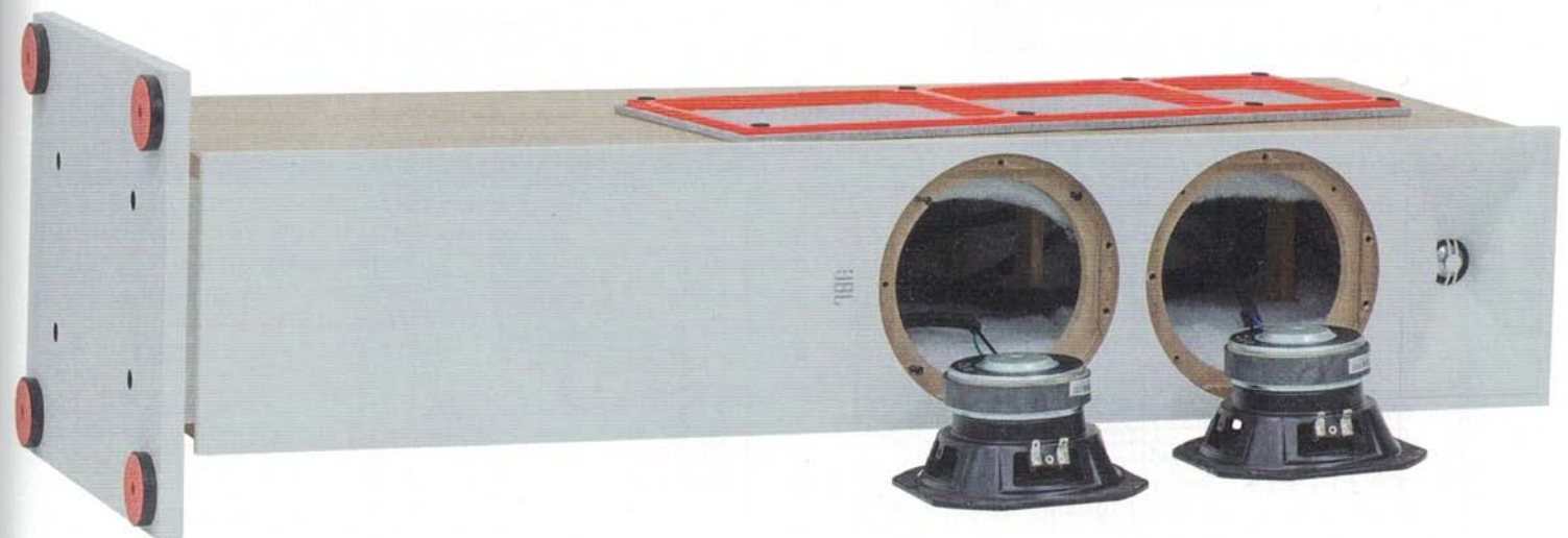
Il diffusore con i suoi componenti. L'interno, con tre setti di rinforzo ma comunque dal volume unico, è coibentato su tre pareti con un cuscino in materiale acrilico. Il tweeter è incollato nel suo vano. Da notare il vezzo della colorazione arancio "JBL" del telaio di copertura e del fondo dei piedini.
