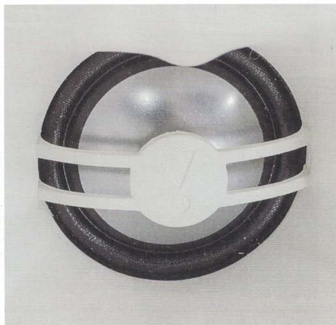
Davanti alla cupola del tweeter, che è in alluminio con anello di sospensione in tela trattata, spicca una lente acustica marcata dal punto esclamativo simbolo di JBL.
